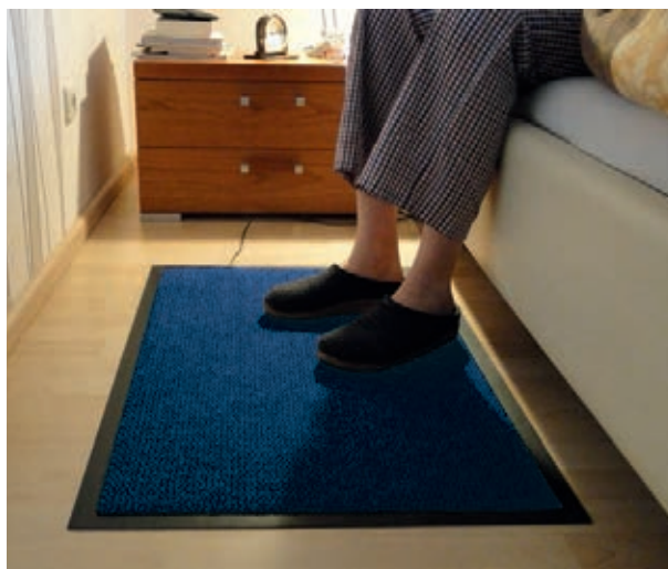
Durch Berührung der Sensormatte wird das Licht auf dem Nachtschrank angeschaltet
