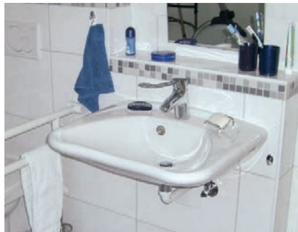
Ein Waschbecken mit Flachsiphon und tiefem Spiegel ist gut im Sitzen zu benutzen.
